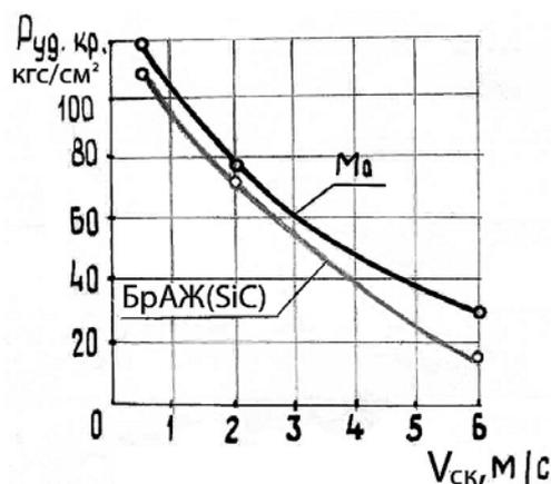
Рис. 2. Зависимости  $P_{уд.кр.}$  от  $V_{ск.}$  для фрикционных плазменных покрытий Мо и БрАЖ(SiC)
